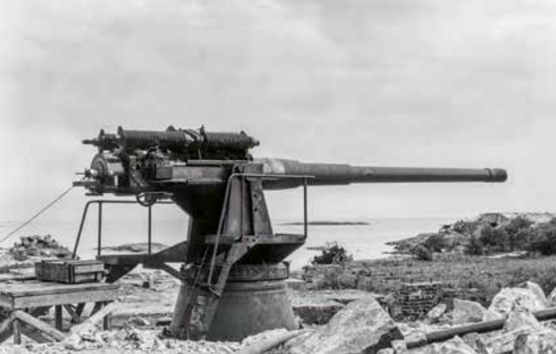
Ensimmäisten 152/50 T-tykkien asennus Mäkiluotoon Porkkalan palautuksen jälkeen. Tykeille asennettiin myöhemmin kilvet.
