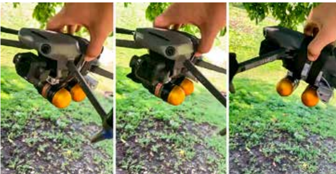
Kaupallinen muunneltu drooni, DJI missä 40mm kranaatti kiinnitettyinä. Pyrstö tehty muovista 3D printterillä.
