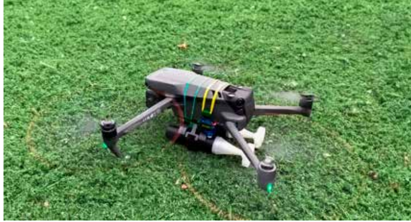
Kaupallinen muunneltu drooni, DJI missä 40mm kranaatti kiinnitettynä. Pyrstö tehty muovista 3D printterillä.
