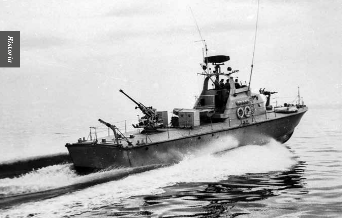
Boforsin tykki asennettuna Nuoli-alukseen.
