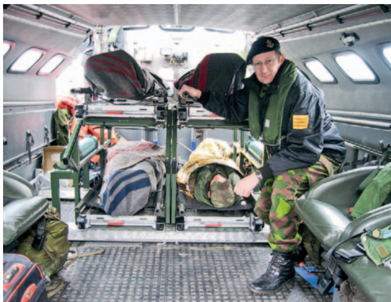
Kuva 7. Jurmo-luokan aluksen 4-paikkainen pariteline meritesteissä. Kuvassa kirjoittaja.
