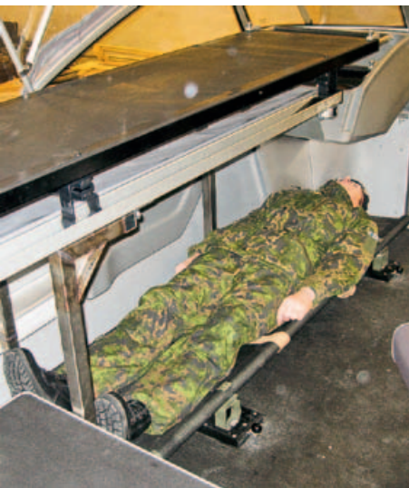
Kuva 4. Evakuointiveneen prototyyppi Buster Magnumiin suunniteltu 2-paikkainen pariteline.
