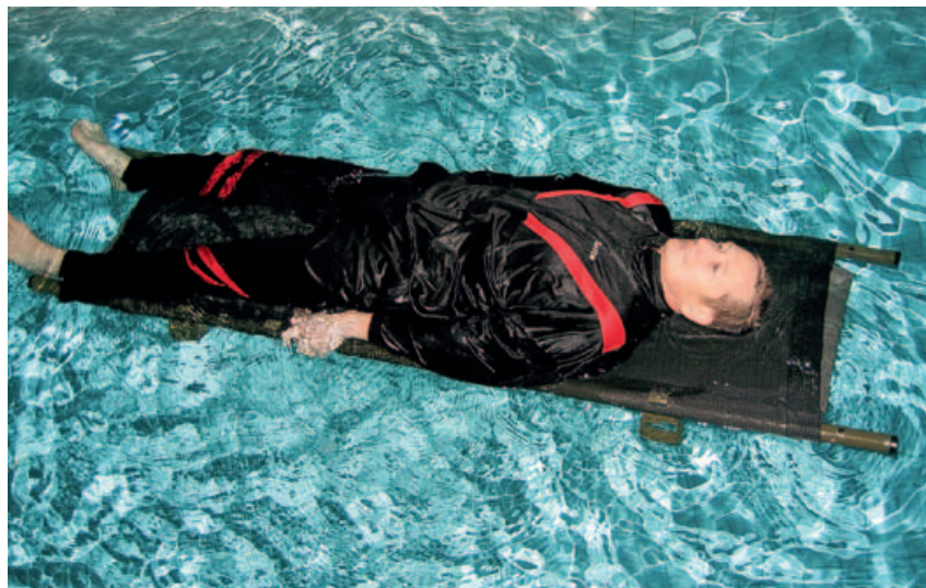
Kuva 5. Nato-paareihin tehdyn kelluttavan materiaalin kenttäkoe.
