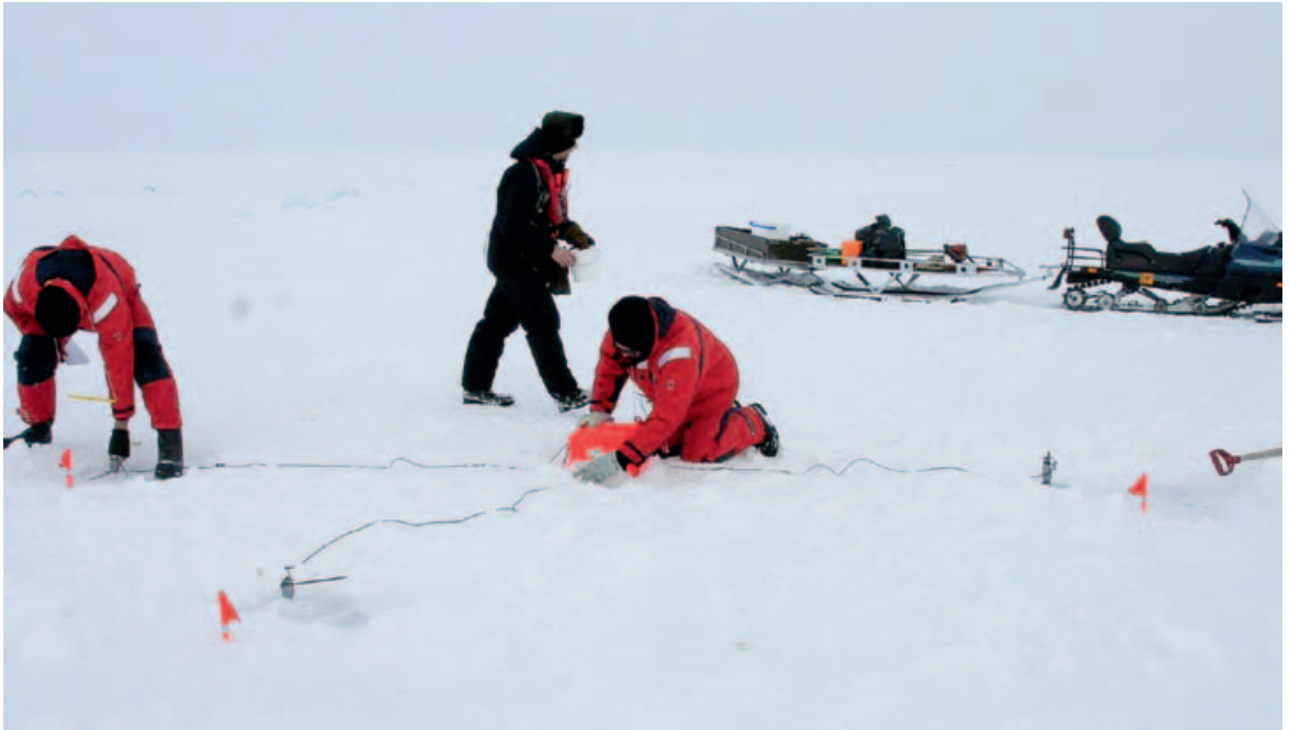
Paineanturien asennus jääkenttään.
