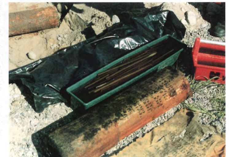
180 mm:n rautatiekin panoksia. Vasemmalta pakkauslieriö, ruuttiputkia vedessä ja kartussi.
