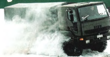
Puolustusvoimien tilaamissa Sisu HMTV 6x6:ssa on Cummins M11 380E dieselmoottori, jonka suurin teho on 278kW/380 hv. Vaihteistona 6-vaihteinen Allison-läysautomaattivaihteisto.
